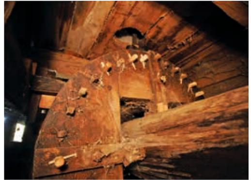
Nach aufwendigen Reparaturarbeiten wurde die "Ortner Mühle" in Treffling- Seeboden so erneuert, dass der Betrieb wieder aufgenommen werden konnte. Die Mühle wurde von den Fundamenten bis zum Dach behutsam in den ursprünglichen Zustand gebracht. Das Mühlrad, der Zulauf und die Mechanik wurden erneuert, sodass das Mahlen von Getreide zu Mehl wieder durchgeführt werden kann.
